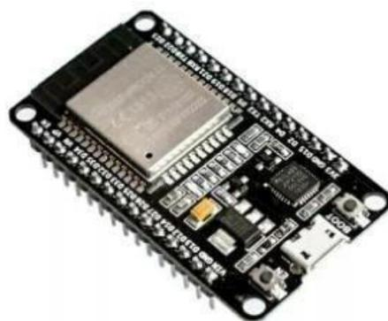
**Gambar 1.** Mikrokontroler ESP32
