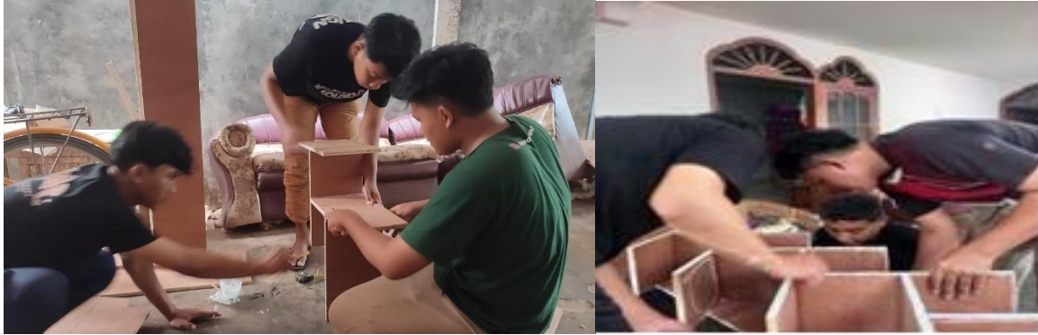
Gambar 1 menyatukan potongan rak serta pengecekan ukuran
