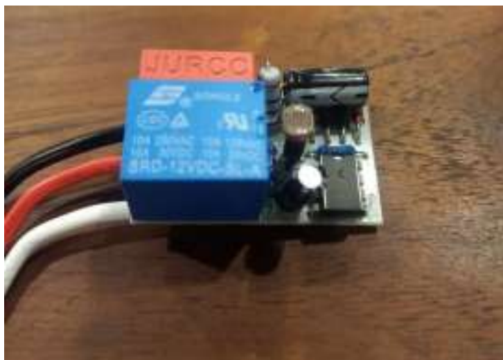
Gambar 1. Elemen dalam Photocell
