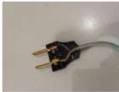
Gambar 4. Pemasangan kabel fasa dan netral ke stecker
