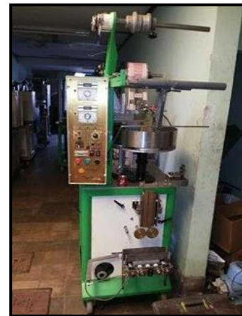
Gambar 6. Mesin Pengemasan Tempe Dengan 2 Penggerak Motor dan 2 elemen pemanas plastic
