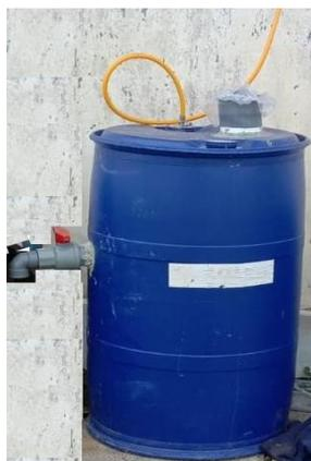
**Gambar 3.** Reaktor Biogas
