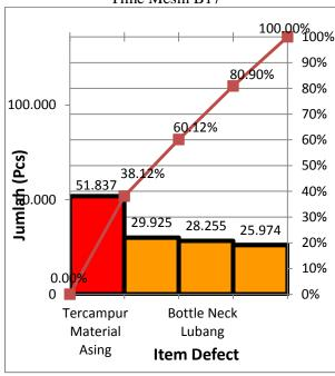
Gambar 5.2 Diagram Pareto Hasil Produk Cacat Mesin B17
