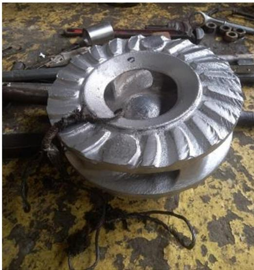
**Gambar 4.** Kerusakan pada *impeller*
