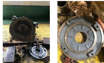
Gambar 5. Penggantian Komponen Pompa Warman Tipe 6/4 E-AH
