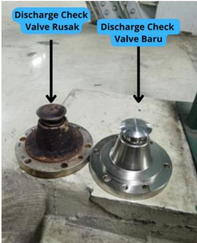
Gambar 4. Perbedaan Discharge Check Valve yang rusak dan yang baru
