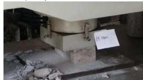
**Gambar 18.** Proses Uji Tekan paving pada pemeliharaan 14 hari
