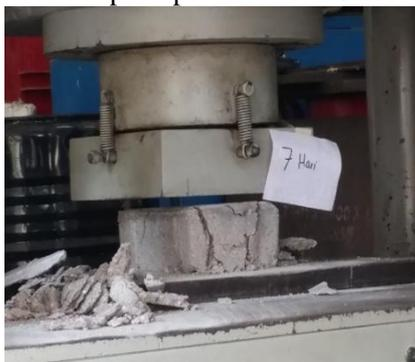
**Gambar 17.** Proses Uji Tekan paving pada pemeliharaan 7 hari
