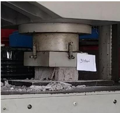
**Gambar 16.** Proses Uji Tekan paving pada pemeliharaan 3 hari
