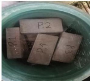
**Gambar 12.** Pemeliharaan paving.
