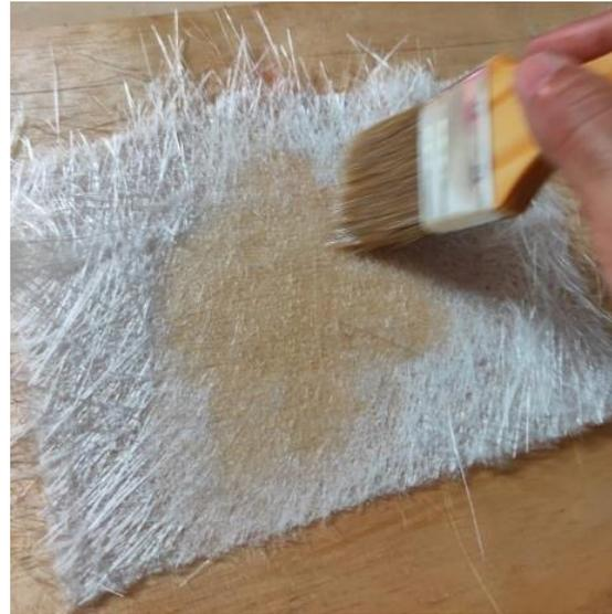
**Gambar 3.** Pengolesan resin pada serat
