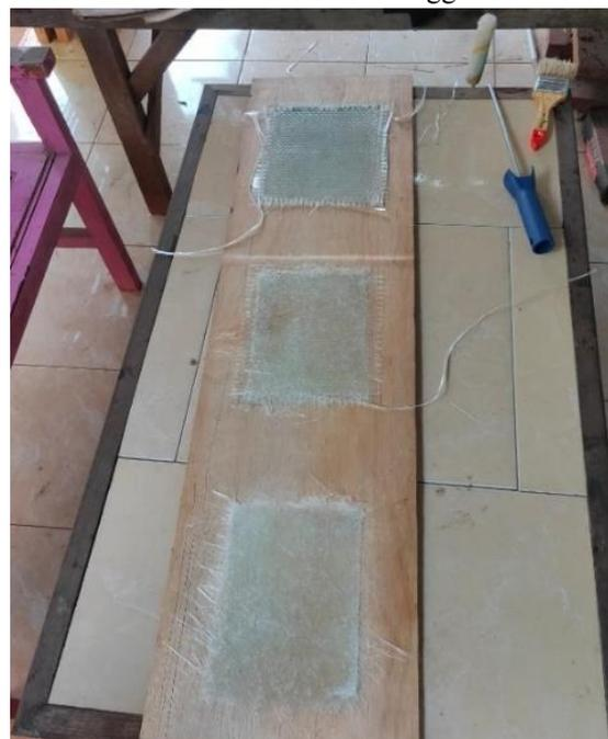
**Gambar 5.** Proses pengeringan Sampel
