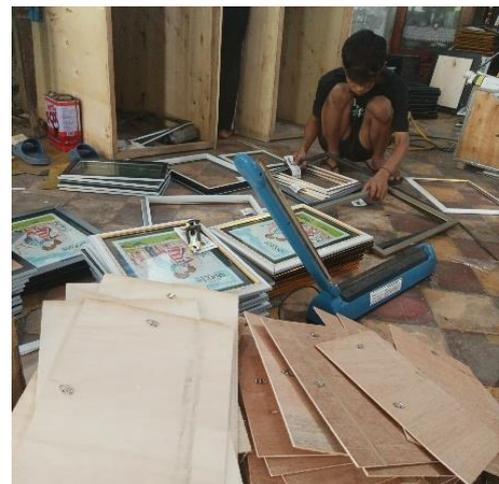
**Gambar 5.** Karyawan 3 Melakukan *Finishing* Pigura Sampai Menghalangi Jalur Pengambilan Hasil Pemotongan Batangan *Frame* Karyawan 2
