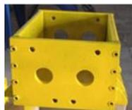
**Gambar 1** Rumah pencacah mesin *Crusher* Skala Lab Limbah Telepon Genggam.
