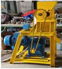
**Gambar 12** Mesin Crusher Skala Lab Limbah Telepon Genggam
