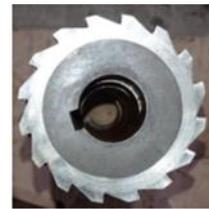
**Gambar 2** Pisau Pencacah Mesin *Crusher* Skala Lab Limbah Telepon Genggam.
