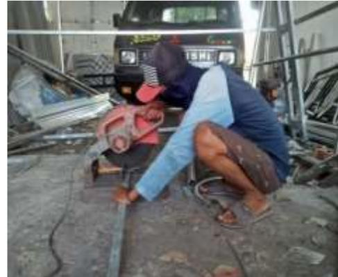
**Gambar 1** proses pemotongan pipa
