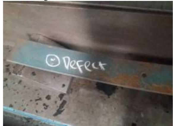
Gambar 1.3 Spring tipe MSM 2230 *Defect* profil jelek
