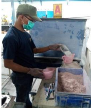
Gambar 2 Proses penuangan material yang sudah ditimbang kedalam cetakan
