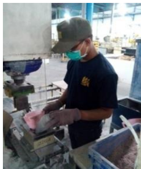
Gambar 2 Proses penuangan material yang sudah ditimbang kedalam cetakan
