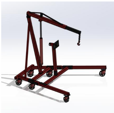
Gambar 3. 1 Desain Penggabungan Engine Stand Dan Engine Crane
