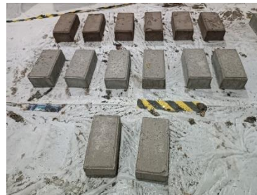
Gambar 3.6 Perawatan Benda Uji
