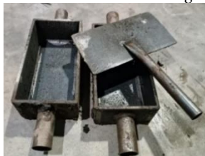
Gambar 3.3 Cetakan Paving block
