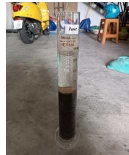
Gambar 3.2 Hasil Pengujian Kotoran Organik Pada Agregat Halus
