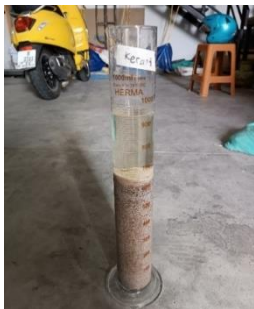
Gambar 3.1 Hasil Pengujian Kotoran Organik Pada Serbuk Cangkang Kerang Hijau
