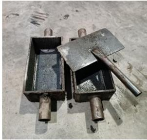
Gambar 3.3 Cetakan Paving Block
