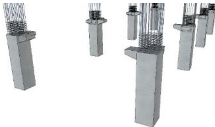
Gambar 3.9 Pelepasan Bekisting Kolom dan konsol
