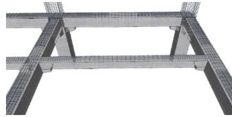
Gambar 3.11 Pemasangan Balok Anak Pracetak
