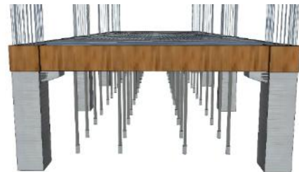
Gambar 3.13 Pemasangan Balok Anak Pracetak
