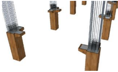
Gambar 3.8 Pengecoran Kolom dan konsol
