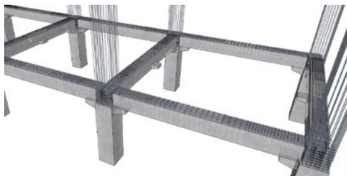
Gambar 3.10 Pemasangan Balok Induk Pracetak
