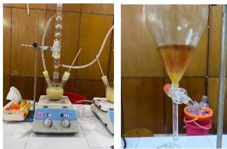
Gambar 2. Rangkaian alat transesterifikasi in-situ
