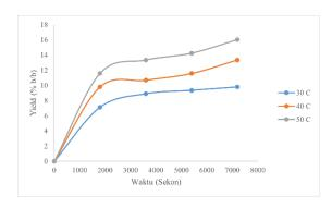
Gambar 1. Pengaruh Waktu Kontak pada Ekstraksi
