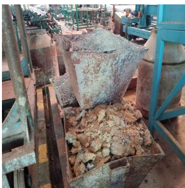
Gambar 2. Limbah zinc ash (Sumber: dokumentasi pribadi)
