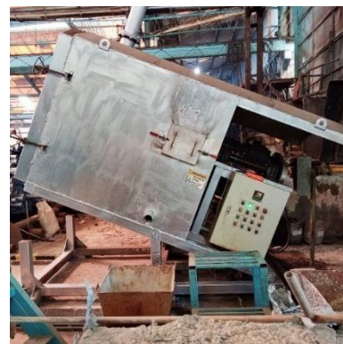
Gambar 7. Proses zinc recovery (Sumber: dokumentasi pribadi)
