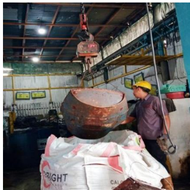
Gambar 13. Proses penimbangan dan pencatatan limbah padat B3 (Sumber: dokumentasi pribadi)
