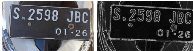
Figure 9. Edge Detection Process
