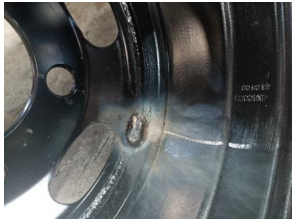
Gambar 2. Kecacatan Pengelasan Tipe Good
