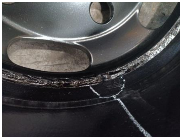
Gambar 1 Kecacatan Pengelasan Tipe Rework
