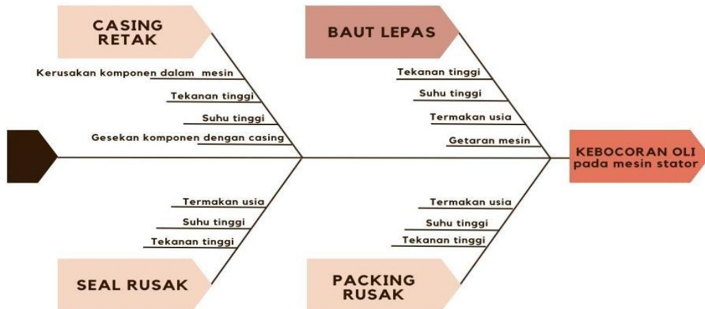
Gambar 1. Fishbone diagram kerusakan yang mengakibatkan kebocoran oli
