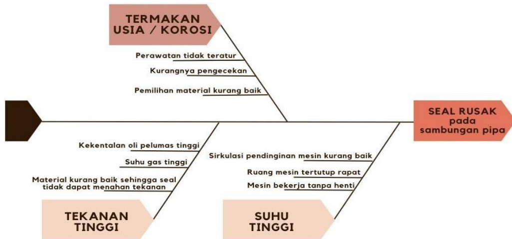
Gambar 2. Fishbone diagram kerusakan yang mengakibatkan seal rusak pada sambungan pipa
