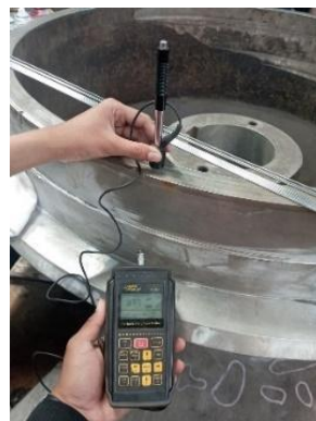
Gambar 5. Uji kekerasan pada impeller
