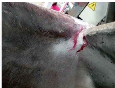
Gambar 3. Penetrant test pada impeller
