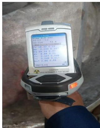
Gambar 2. XRF pada impeller
