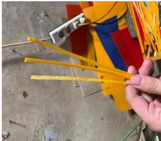
Gambar 1. kawat las plastik (fillerrod)
