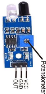
Gambar 2. Sensor Kecepatan IR Infrared Barrier Obstacle Avoidance
