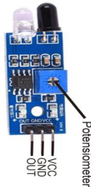
Gambar 2. Sensor Kecepatan IR Infrared Barrier Obstacle Avoidance
