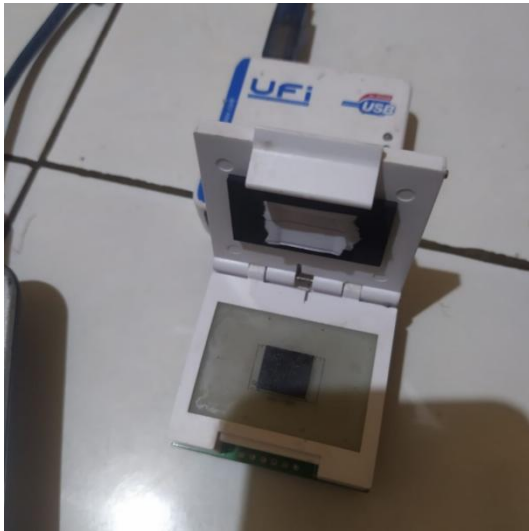
Gambar 11 Pemasangan eMMC pada adpter UFI BOX
