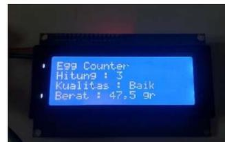
**Gambar 5.** LCD hasil pembacaan sensor
