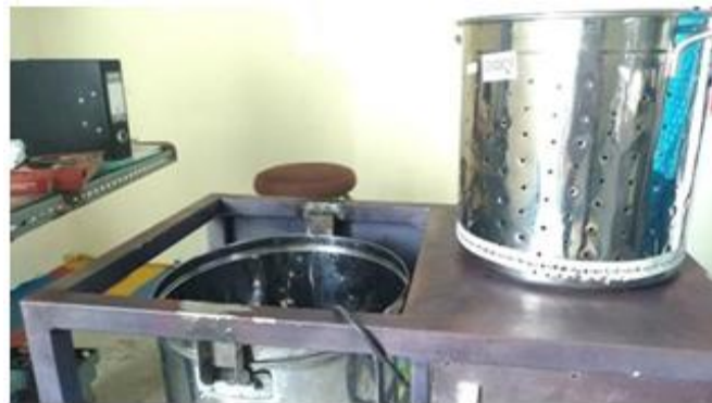
Gambar 3. Alat bantu berupa perajang semi-otomatis
