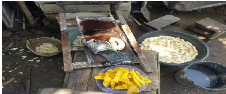
Gambar 2. Alat bantu berupa perajang semi-otomatis
