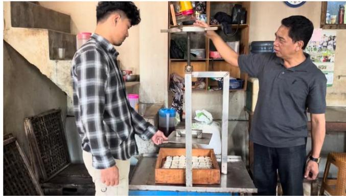
**Gambar 6.** Proses Pengepresan Tahu dengan Mesin Press Mekanis
