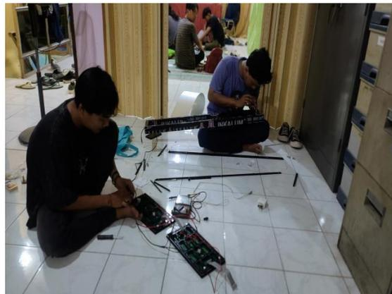
**Gambar 1.** Proses Perakitan Running Text
