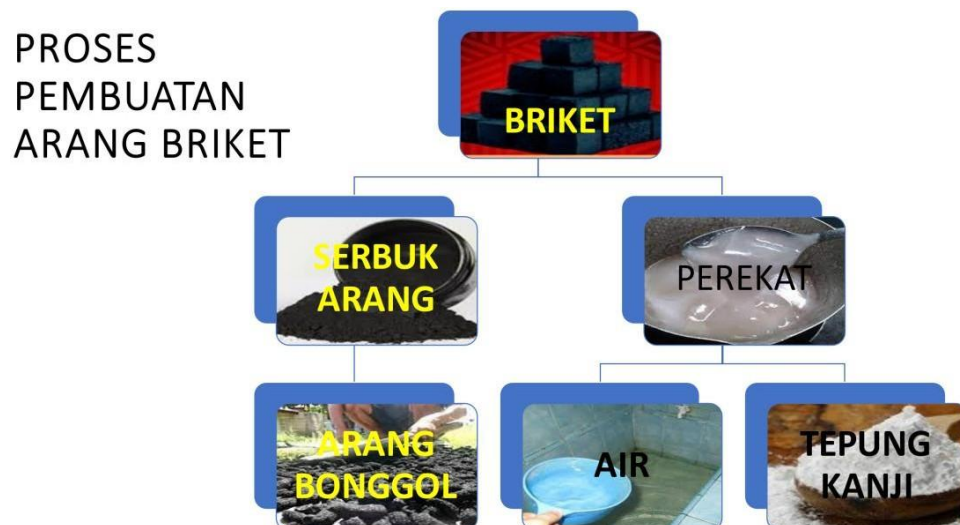
Gambar 3. Proses Pembuatan Arang Briket Bonggol Jagung
