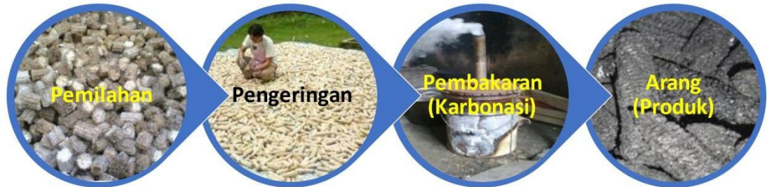
Gambar 2. Proses Pengarangan Bonggol jagung
