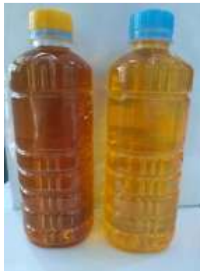
Gambar 2. Minyak Jelantah Sebelum (Kiri) dan Setelah (Kanan) Proses Pemurnian
